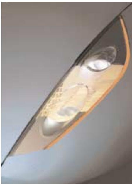
Les feux arrière, en amande, prolongent la ligne de caisse de leur arête vive. Deux LED de forte puissance éclairent des lamelles de verre parallèles et créent un flux lumineux à la fois longitudinal et latéral.
